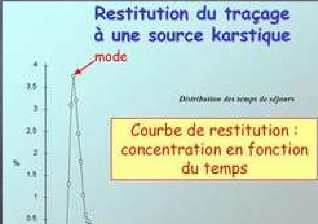
Figure 4.2: Schéma d'une courbe de restitution obtenue suite à un essai de quantitatif. Le centre de gravité de la courbe de restitution correspond au temps de parcours moyen du traceur dans l'eau souterraine.
